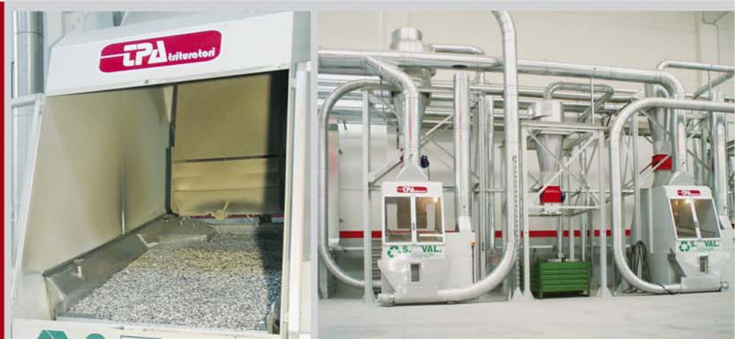
▲ Linea di separazione densimetrica dei materiali solidi non ferrosi
