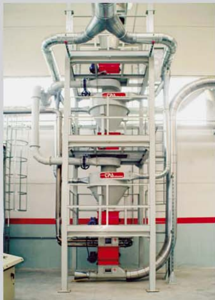
▲ Impianto di trasporto della plastica con relativo stoccaggio e filtrazione dell'aria
